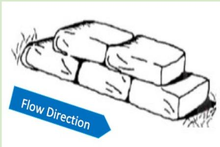
Las bolsas deben colocarse a lo largo y sobreponerse, como ladrillos, paralelas a la dirección de la corriente del río. Los apilamientos de más de 2 bolsas de arena de alto deben colocarse como una pirámide con una base ancha. Para lograr estabilidad, el dique debe ser tan corto y bajo como sea posible. Compacte cada bolsa de arena en su lugar pisándolas. Asegúrese de que cada bolsa esté bien apretada contra la próxima
